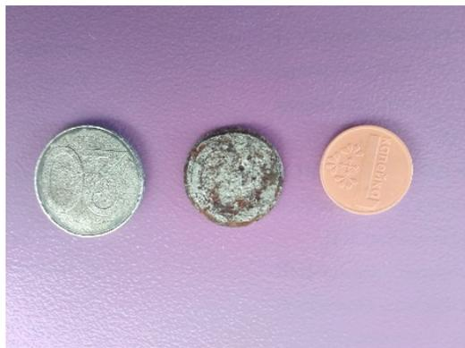
Рисунок 2. Результат растворения спустя трое суток (деформирование металлической основы)
