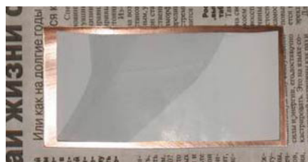
Рис. 2 Размещение печатной платы на текстолите
