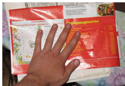
Рис. 4 Проглаживание руками печатной платы на текстолите
