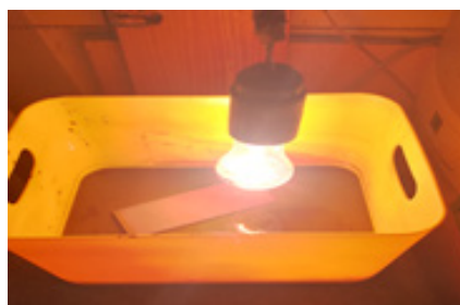
Рис. 7 Процесс травления в растворе хлорного железа
