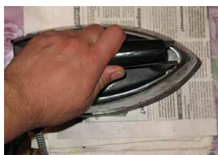
Рис. 3 Проглаживание утюгом печатной платы на текстолите
