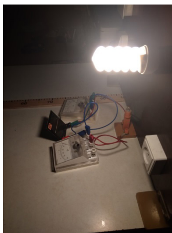
Рис. 4: Проведение эксперимента с 1 солнечной батареей на расстоянии 25 см
