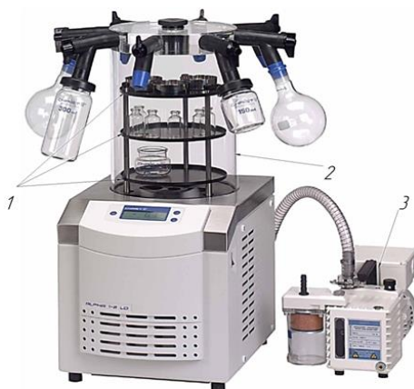
Рисунок 1.-Ллиофилизатор: 1 – полки; 2 – сушильная камера; 3 – вакуумный насос.
