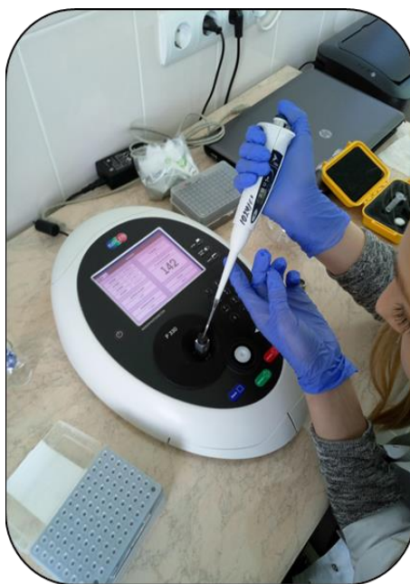
Определение степени очистки и концентрации нуклеиновых кислот и белка на наноспектрометре
