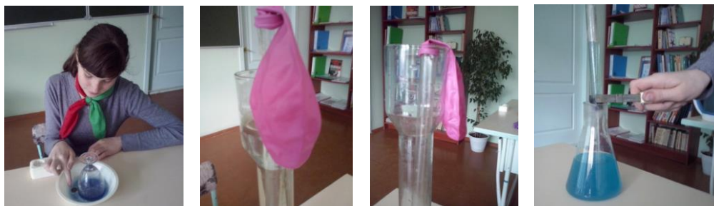
Фото 3. Опыты по определению зависимости давления воздуха от температуры при условии, что масса и объём газа не изменяются
