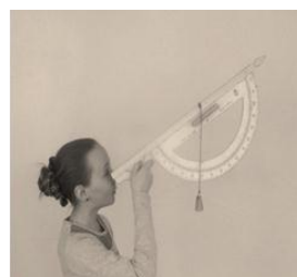
Рис. 3. Измерение высоты светила эклиметром
