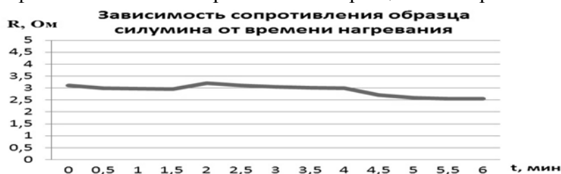
Рисунок 3. График зависимости сопротивления образца №2 от времени его нагревания
