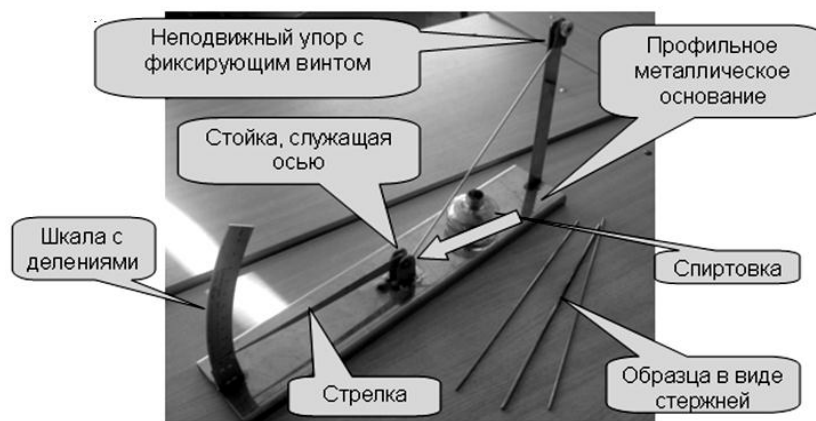
Рисунок 2 – Усовершенствованный вариант прибора для демонстрации теплового расширения металлического стержня
