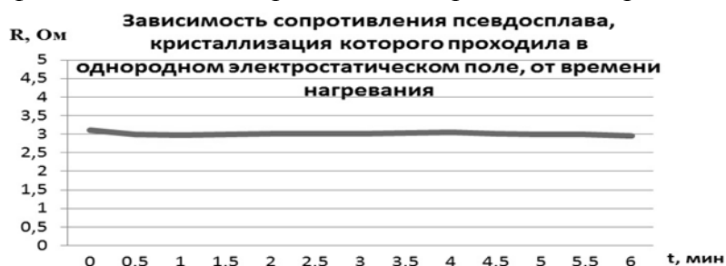
Рисунок 4. График зависимости сопротивления образца №3 от времени его нагревания
