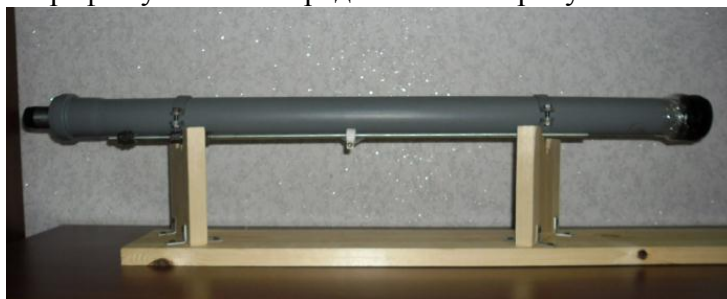
Рисунок 3. Сконструированный длиннофокусный микроскоп
