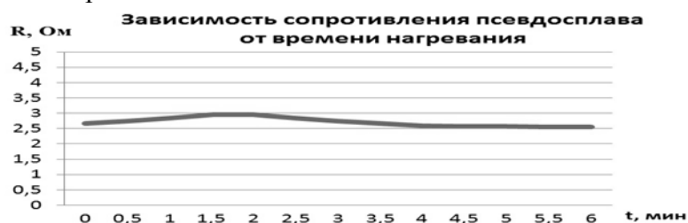
Рисунок 2. График зависимости сопротивления образца №1 от времени его нагревания
